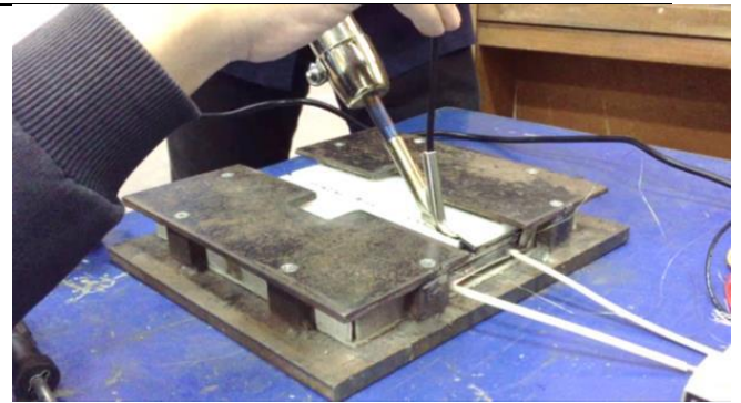
Gambar 2. Pengelasan HGW pada Lembaran HDPE
