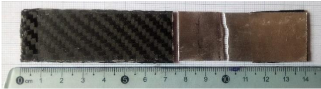
Gambar 7 Specimen uji geser patah pada aluminium
