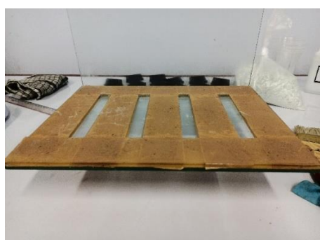
Gambar 6. Cetakan Spesimen Uji Tekan
