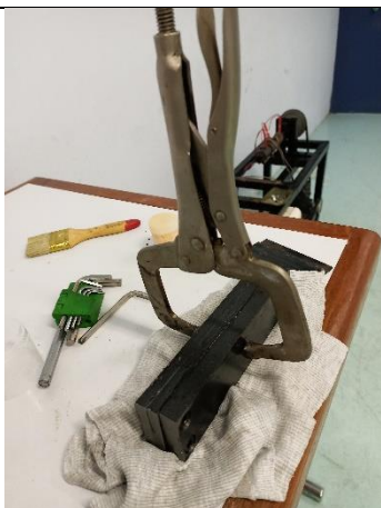
Gambar 8. Proses Curing Spesimen Uji Tarik
