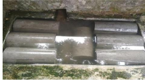
Gambar 4.1 Proses Perawatan Benda Uji
