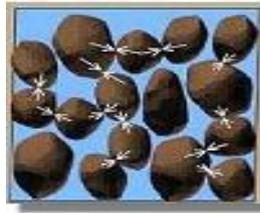
**Gambar 3.** Kondisi partikel tanah saat mengalami getaran saat terjadinya kenaikan tekanan air pori
