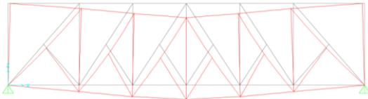
**Gambar 9.** Lentutan pada Jembatan Tipe Baltimore Truss
