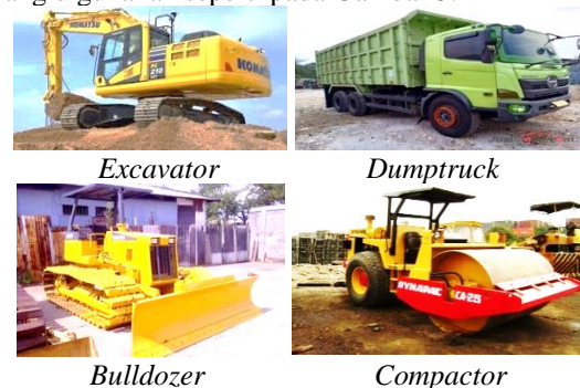
Gambar 3. Contoh Alat Berat Pekerjaan Tanah
