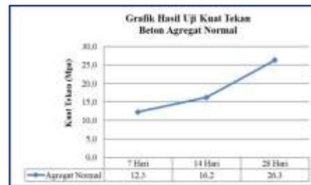
**Gambar 7.** Grafik Kuat Tekan Beton Agregat Kasar Normal
