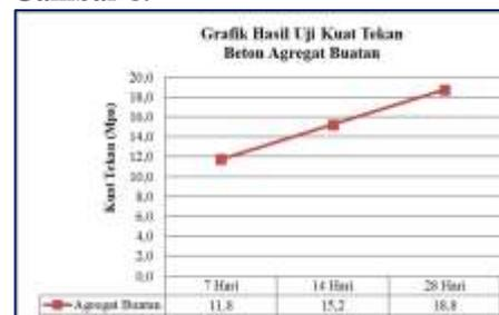
**Gambar 8.** Grafik Kuat Tekan Beton Agregat Kasar Buatan
