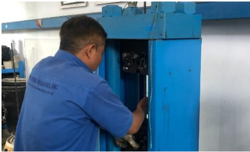
Gambar 6. Dokumentasi pengujian kuat tarik baja
