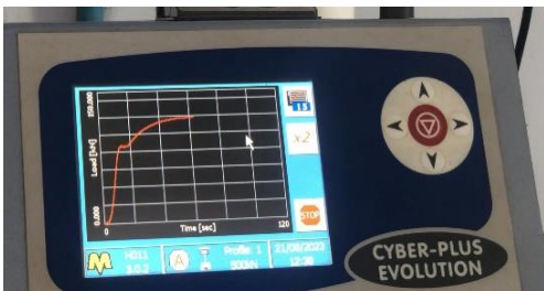
Gambar 7. Dokumentasi pengujian kuat tarik baja
