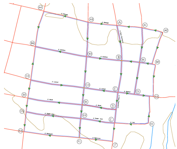
Gambar 9. Skema Jaringan Drainase
