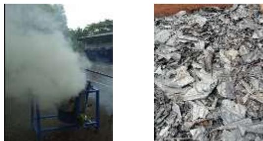
Gambar 3. Simulasi pembuatan biochar dari daun kering menggunakan alat pirolisis
