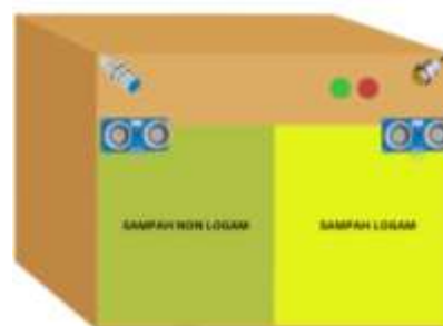
Gambar 3. Rancangan Tempat Sampah Otomatis
