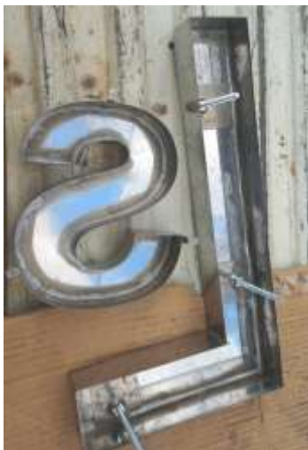
Gambar 4. Contoh desain huruf stainless steel yang pengikatannya dengan menggunakan Sekrup dan pengikatan dengan cara Baut-mur
