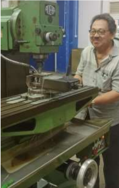
Gambar 3. Penipisan ketebalan pelat penahan ujung belakang punch
