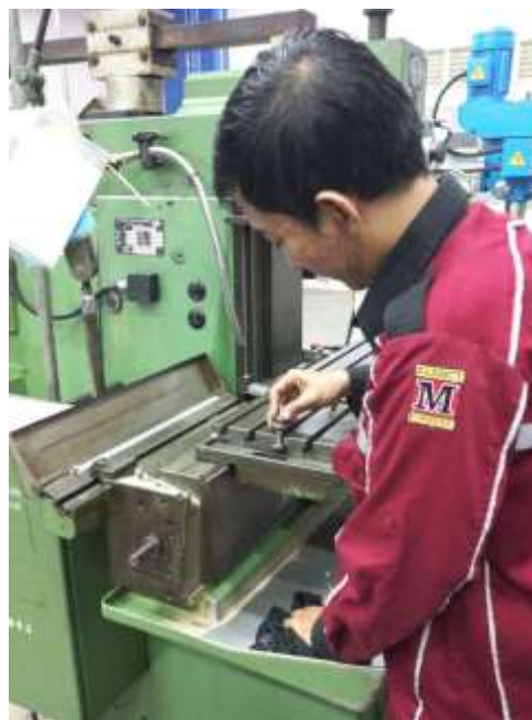
Gambar 2. Persiapan pengefraisan pada komponen penahan ujung belakang punch
