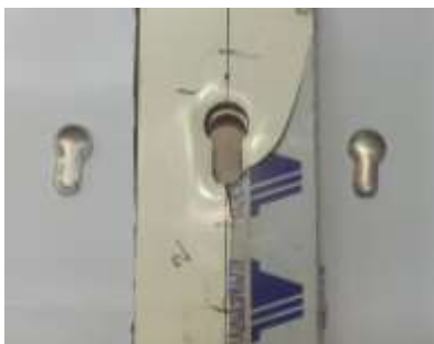
Gambar 9. Hasil uji coba pelubangan menembus profil Aluminium hollow
