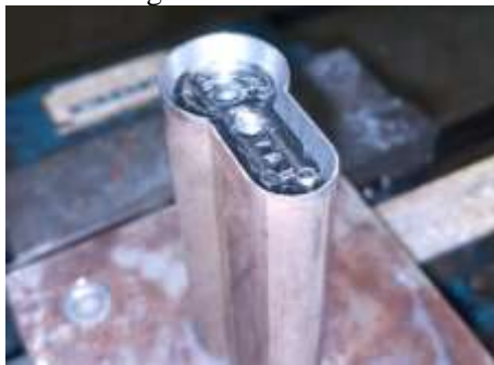
Gambar 8 Hasil pembuatan sisi tajam punch dengan Frais CNC
