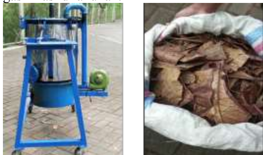
Gambar 1. Alat gasifikasi dan bahan baku sampah daun kering
