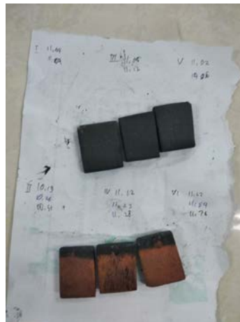
Gambar 3. Keramik yang setelah electroless (atas) dan elektroplating (bawah)
