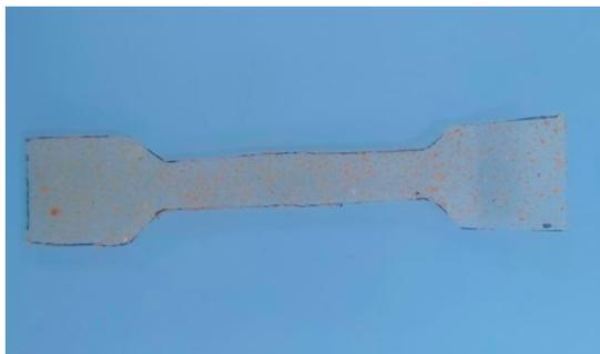
**Gambar 3.** Sampel pengujian kuat tarik
