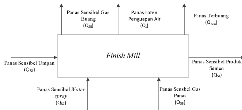
Gambar 3.2 Skema neraca energi finish mill
