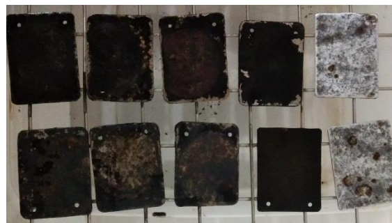
Gambar 2. Pelapisan baja dengan green corrosion Inhibitor
