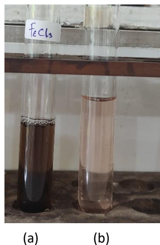
Gambar 2. Hasil uji kualitatif bubuk pewarna alami (a) larutan bubuk pewarna alami dan \text{FeCl}_3 ; (b) larutan bubuk pewarna alami
