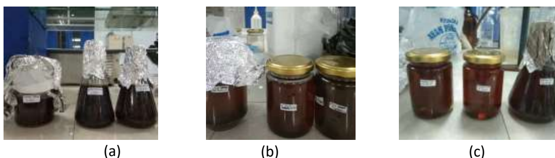
Gambar 1. Hasil ekstraksi kulit buah pisang kepok 10,15, 20 gram dengan pelarut aseton 300 ml: (a) Soxhlet, (b) Maserasi, (c) UAE
