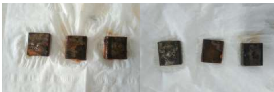
Gambar 4. Hasil pelapisan GCI pada hasil ekstrak kulit pisang kepok setelah pengangkatan dan pembersihan baja karbon
