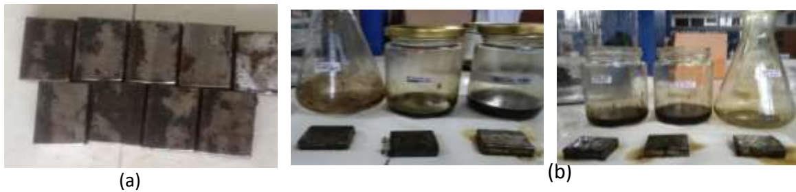
Gambar 2. Pelapisan GCI: (a) Sebelum dilapisi GCI, (b) Setelah dilapisi GCI
