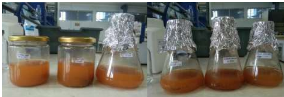
Gambar 3. Hasil pelapisan GCI pada hasil ekstrak kulit pisang kepok setelah perendaman 14 hari menggunakan NaCl
