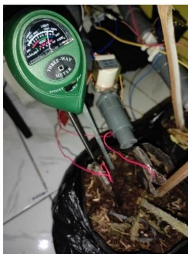
Gambar 12: Pengukuran Dengan Moist Meter Tanaman Tomat 2
