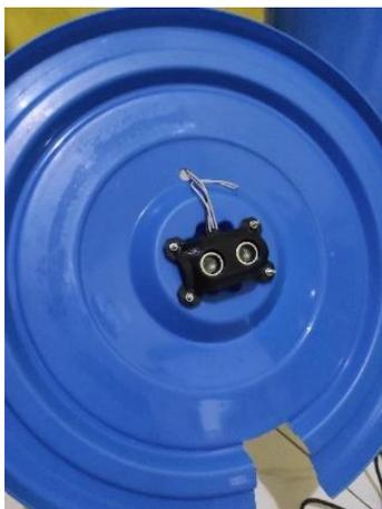
Gambar 4.: Sensor Ultrasonik Pada Tutup Tangki Air
