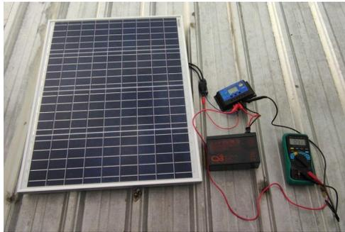
Gambar 8. Pengujian Solar Panel dan Solar Charger Controller
