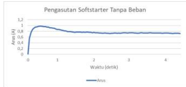
Gambar 13. Grafik Pengasutan Softstarter PID Tanpa Beban
