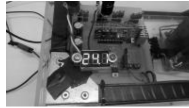
Gambar 7. Pengecekan Input Tegangan
