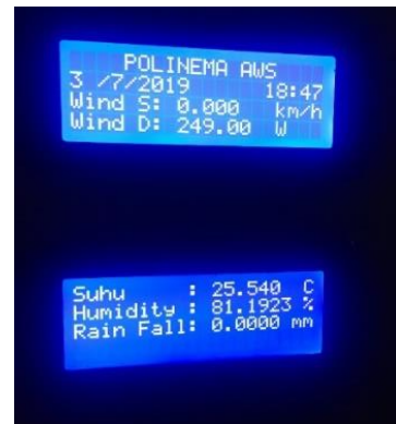
Gambar 10. Pembacaan Sensor Dari Stasiun Cuaca Slave 1
