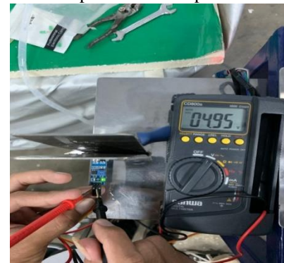
Gambar 19 Pengujian Sensor Photodiode Pada Saat Tidak Ada Filament (3D printing)
