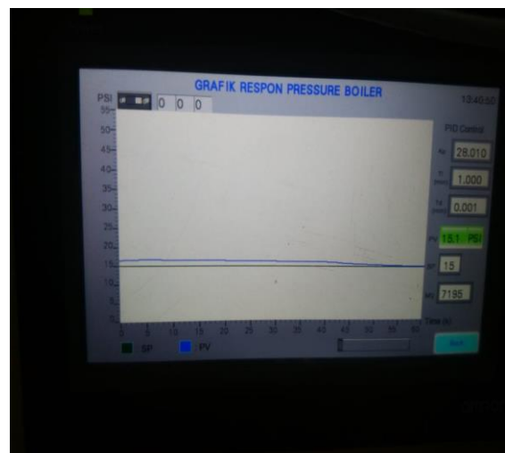
Gambar 15. Grafik Kontrol PID Steady State
