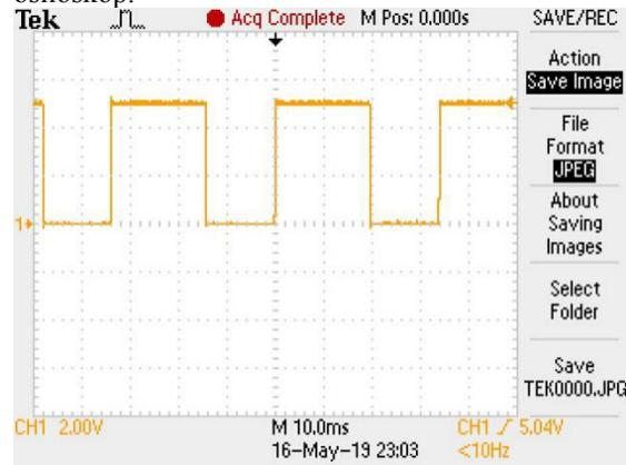
Gambar 11 Pengujian Sensor Obstacle Photodiode
