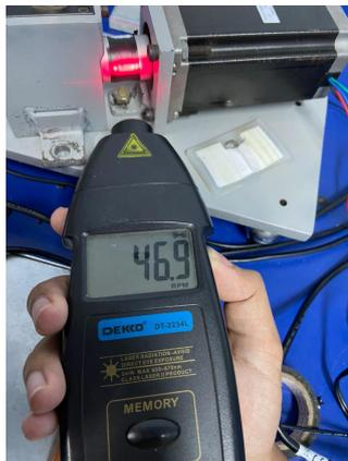
Gambar 13: Pengukuran kecepatan motor stepper
