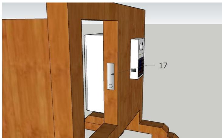
Gambar 4: Posisi Kunci Dropbolt Elektrik
