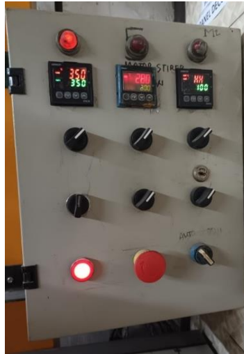
Gambar 12: Rangkaian heater automatic run sudah selesai di pasang dan di test siap digunakan, tampak dalam
