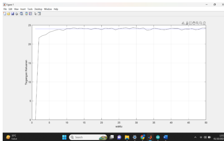
Gambar 6. Grafik Tegangan Keluaran Closed Loop Boost Converter menggunakan PID Controller
