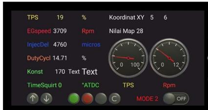
Gambar 9 Pemantauan Serial Monitor Bluetooth
