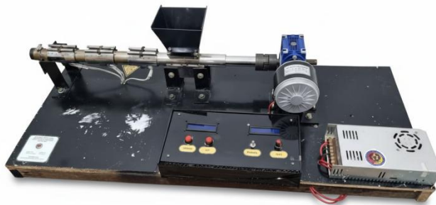
Gambar 1. Implementasi sistem ekstruder filamen berbasis pelet plastik daur ulang
