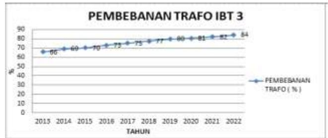
Gambar 6. Pembebanan trafo IBT 3 500 / 150 KV GITET Paiton
