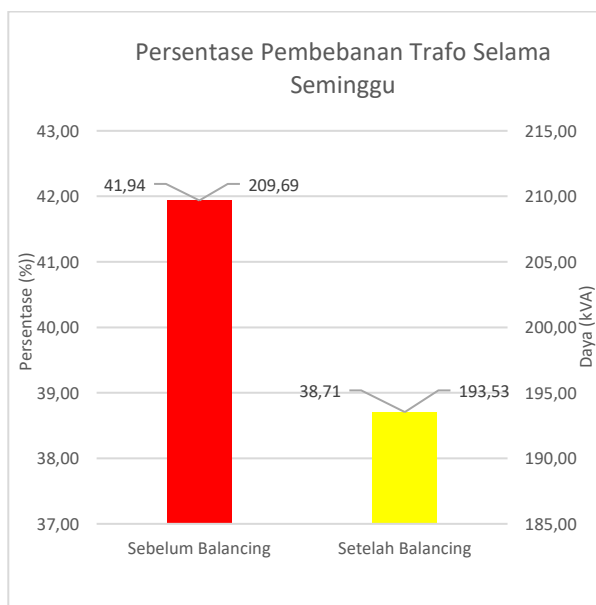
GAMBAR 3.6 GRAFIK % PEMBEBANAN TRANSFORMATOR 2 SEBELUM DAN SESUDAH BALANCING
