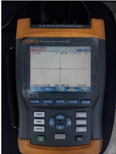
GAMBAR 3.5 GELOMBANG ARUS KELUARAN INVERTER TANPA BEBAN
