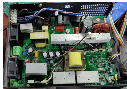
GAMBAR 3.2 RANGKAIAN INVERTER HYBRID
