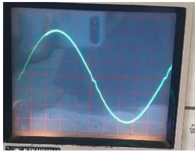
Gambar 4.6 Gelombang Keluaran Kotak Kontak
