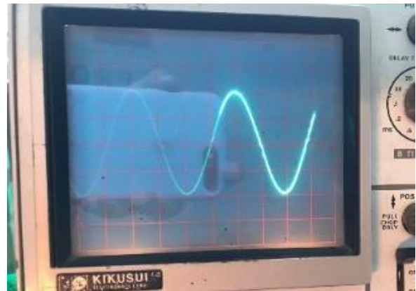
Gambar 4.5 Gelombang Keluaran Lampu LED
