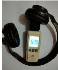
Gambar 8. Pengujian menggunakan Sound Level Meter
