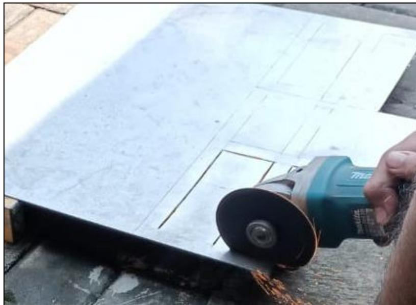
Gambar 4. Proses Pematangan Plat Untuk Komponen Pengaduk
