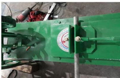
Gambar 3. Pemasangan dan Penyetelan Pipa
