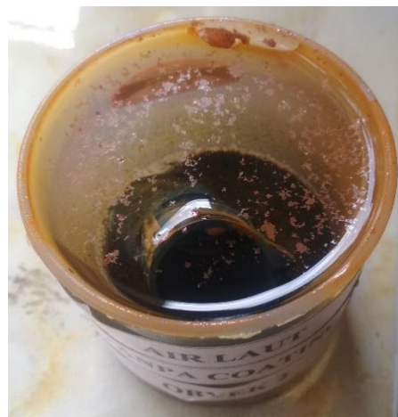
Gambar 4 proses pengujian korosi dengan media air tawar
