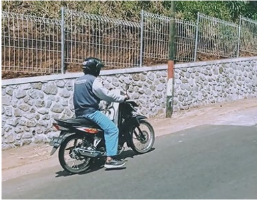
Gambar 3. Proses uji konsumsi kendaraan pada medan miring
