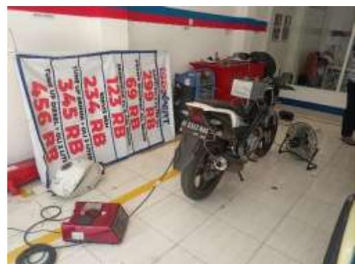
**Gambar 2.** Setting Peralatan Pengujian Emisi Gas Buang
