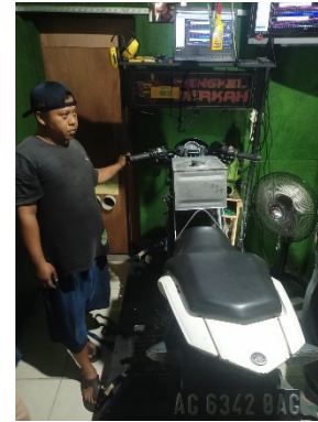
Gambar 1. Setting Peralatan Pengujian pada Dyno
