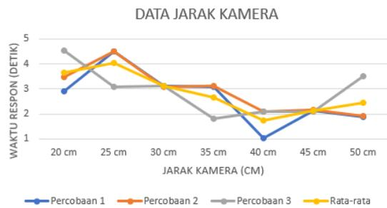
**Gambar 4.** Grafik pengujian jarak kamera terhadap waktu respon dengan menggunakan antena
