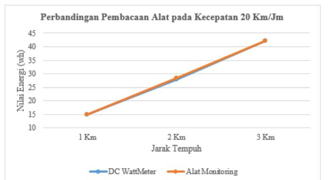
**Gambar 4.** Grafik Perbandingan Pembacaan alat DC Wattmeter dengan Alat Monitoring
