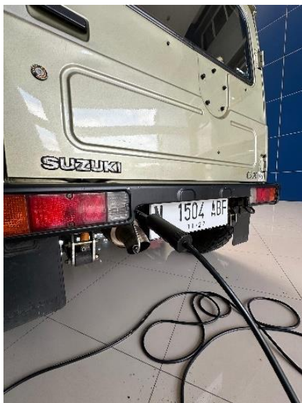
Gambar 1 Pengujian emisi gas buang
